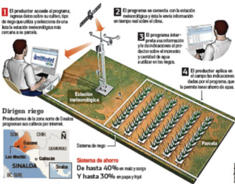
Figura 8. Diagrama de flujo para la programación integral y la gestión del riego en tiempo real a través de internet con la plataforma IRRIMODEL.
