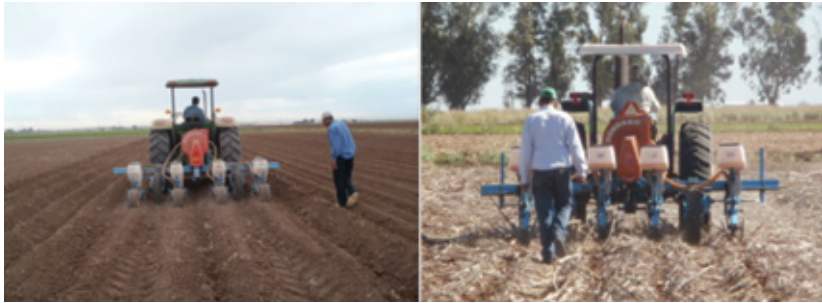
Figura 1 y 2. Siembra tradicional en terreno labrado (izq.) y siembra directa en terreno sin preparación y con cobertura de paja (der.).
