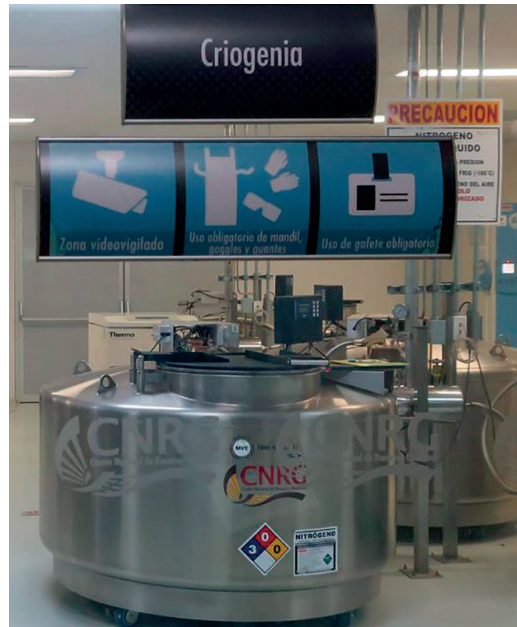
Tanque criogénico para almacenar muestras Centro Nacional de Recursos Genéticos
